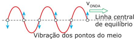
Considere que a onda se propague para a direita. A velocidade de propagação define o sentido de movimento da onda e mede a rapidez com a qual a energia se desloca através do meio. Observe que cada ponto da corda (círculos brancos) se desloca para cima e para baixo, em torno da linha central de equilíbrio, enquanto a onda se desloca através da corda para a direita.
